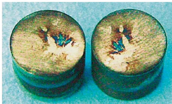
Рис. 5. Поверхность роликов после копровых испытаний с взрывными превращениями навесок октогена
