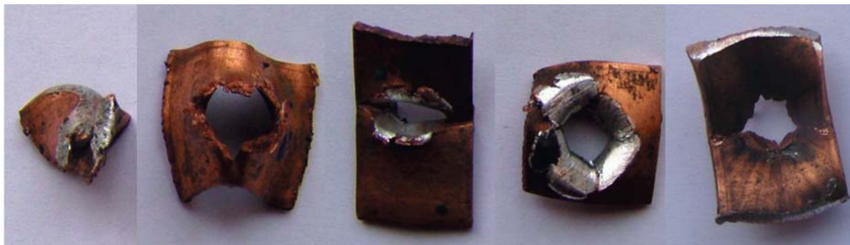
Рис. 6. Внешний вид пластин-свидетелей после воздействия на мишень ЛИ, вызывающего инициирование алюминизированного ВВ
