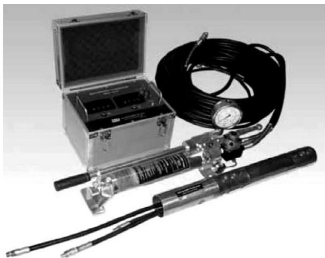
Рис. 3. Внешний вид прессиометра для измерения давления в шпуре
