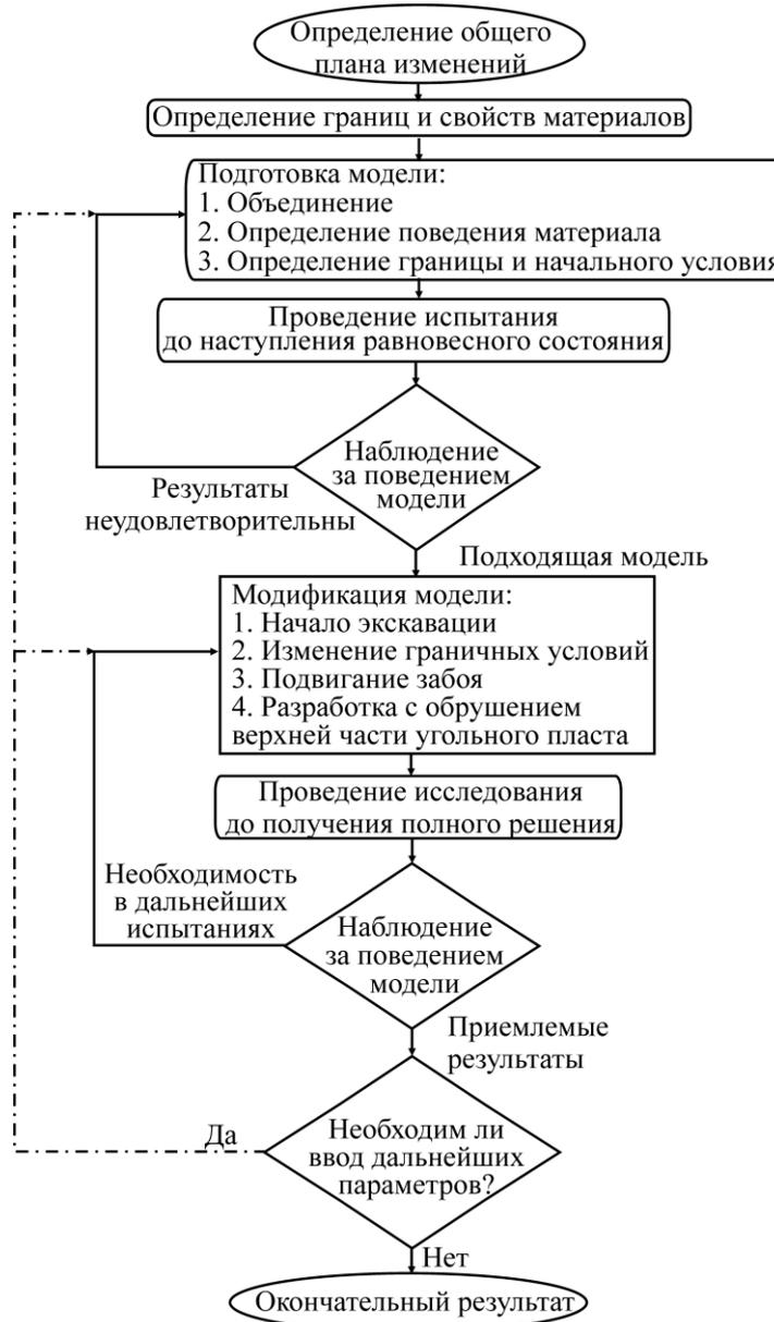
Рис. 4. Принцип цифрового моделирования [29]
