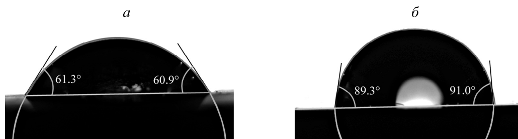
Рис. 7. Фотографии, полученные на приборе измерения краевого угла смачивания DSA25, на чистой поверхности галенита (а) и после обработки в растворе КПДЭ 20 мг/л и БКК 20 мг/л (б)
