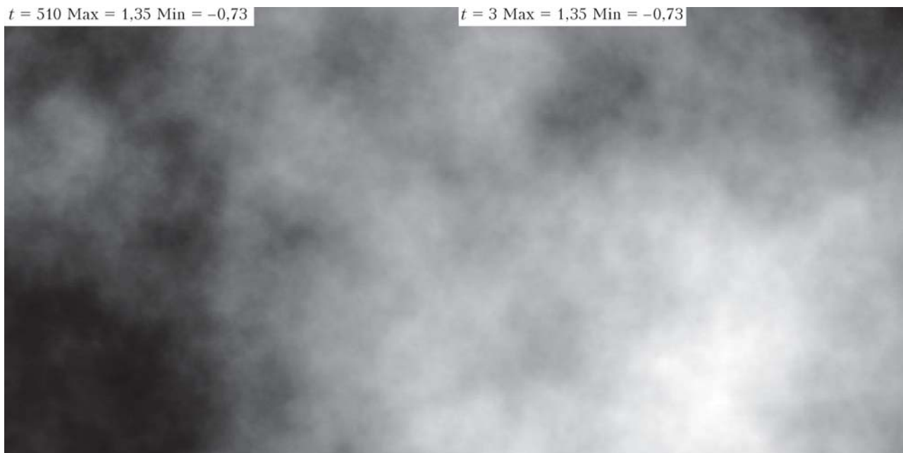
Рис. 1. Пример реализации фазового экрана, описывающего турбулентные флуктуации фазы на участке трассы длиной 10 м в атмосфере. Значения фазы отображаются градиациями серого от минимального значения -0,73 (черный) до максимального 1,35 (белый). Размер экрана 75 \times 37,5 см. Внешний масштаб турбулентности L_0 = 1 м, внутренний l_0 = 2 мм
