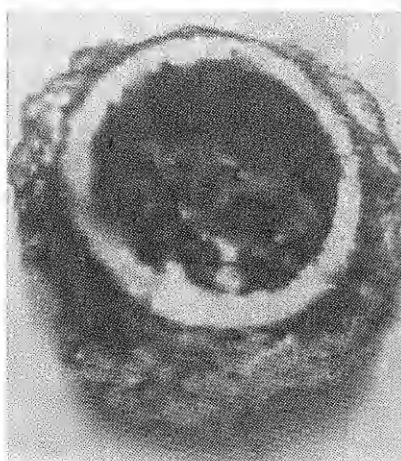
Рис. 7. Поперечный распил недогоревшего крупного образца магния.
