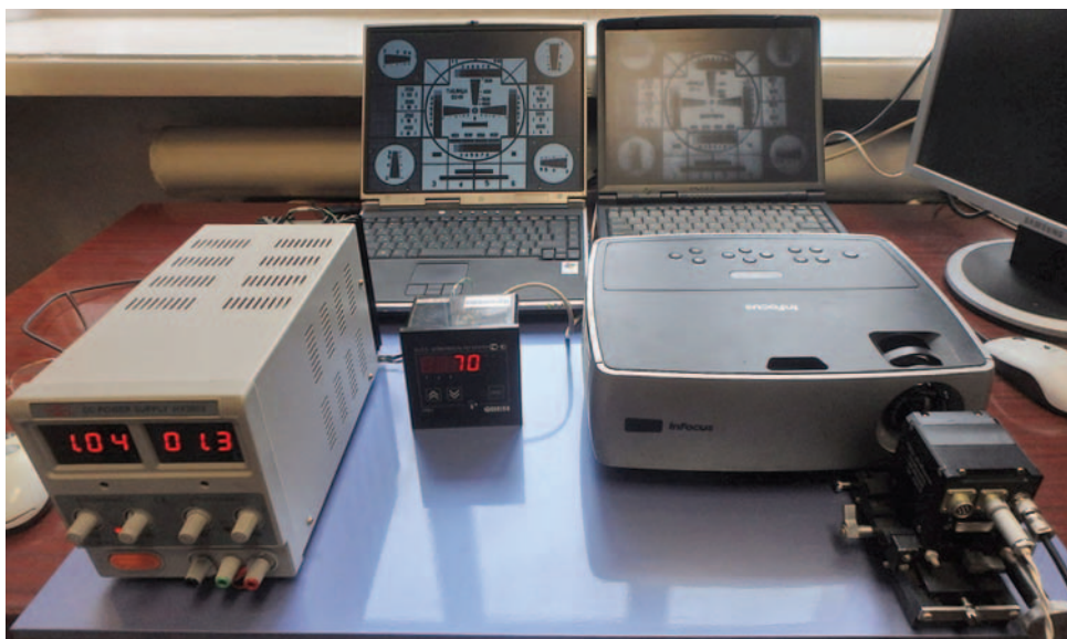
Рис. 7. Стенд для генерации изображений в области 8–12 мкм
