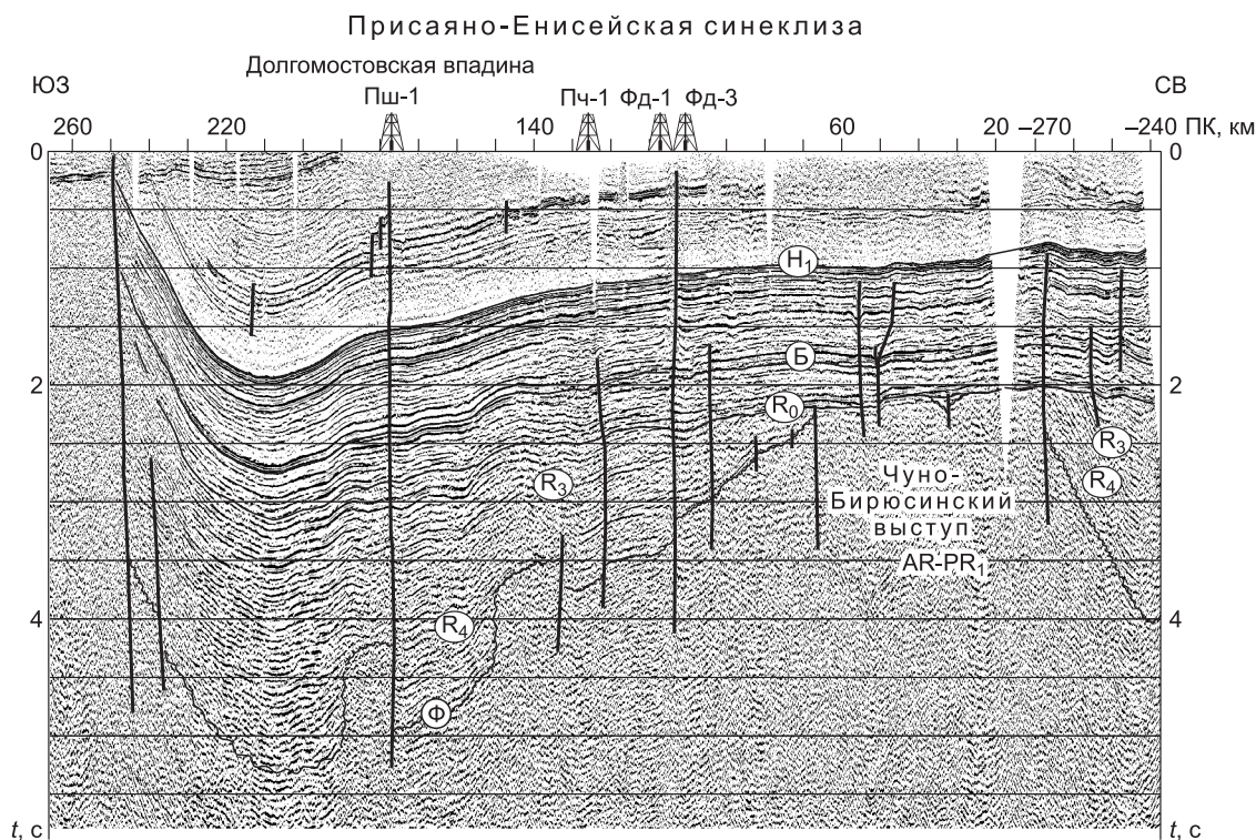
Рис. 7. Временной разрез по опорному маршруту Карабула—Восточный Саян (северный фрагмент).
