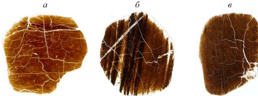
Рис. 1. Фрагменты систем трещин в шлифах углей
