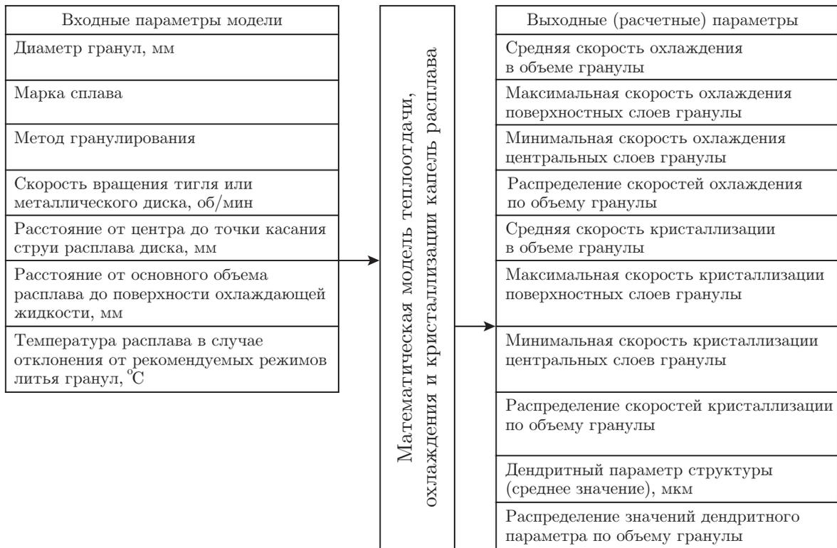
Рис. 3. Комплекс входных и выходных параметров разработанной математической модели для анализа процессов теплоотдачи и кристаллизации капель расплава алюминиевых сплавов
