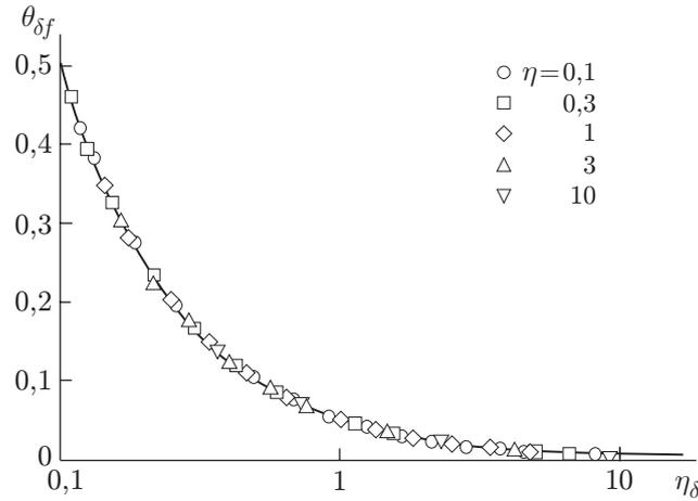
Рис. 4. Автомоделная зависимость критического периода колебаний  $\theta_{\delta f}(\eta_\delta)$ : точки — решение уравнения (4) при  $1,1 \leq \delta \leq 10$ ,  $0,1 \leq \eta \leq 10$ ; кривая — зависимость (5)
