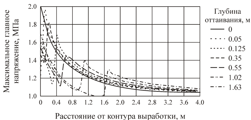
Рис. 3. Изменение максимального главного напряжения в породном массиве для выработки круглого сечения при различных глубинах оттаивания. Падение модуля упругости при оттаивании составляет 30 %
