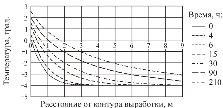
Рис. 2. Изменение температуры в породном массиве вокруг выработки в различные моменты времени
