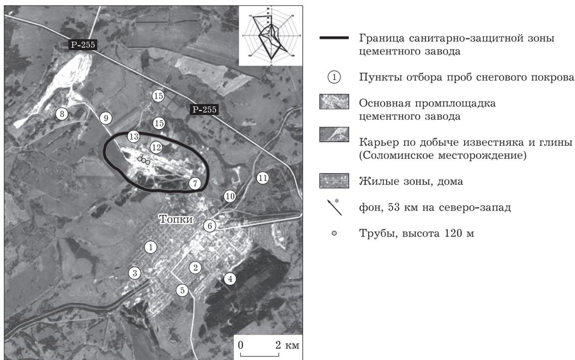
Рис. 1. Карта отбора проб снегового покрова в зоне воздействия цементного завода и на территории г. Топки (<https://www.google.ru/maps/> с дополнениями авторов; пробы № 1–6 – жилая зона г. Топки, пробы № 7, 12, 13 – санитарно-защитная зона завода; пробы № 7, 10, 11 – юго-восточная зона воздействия; пробы № 9, 12–15 – северо-западная зона; пробы № 13–15 – северная зона; проба № 8 – район карьера по добыче известняков и глин).
