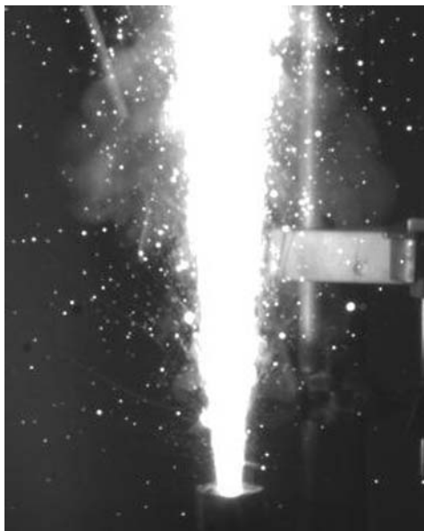
Рис. 3. Горение стехиометрической смеси титана с 50 % оксида меди. Огненный факел
