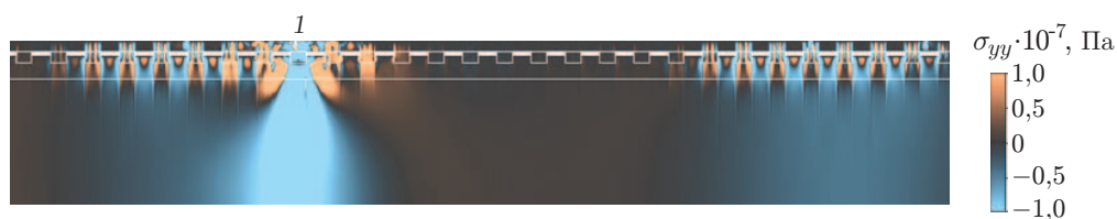
Рис. 6. Распределение главной вертикальной компоненты тензора напряжений Коши и образование трещины в случае одного свича (скорость состава — 120 км/ч, t = 3,6125 \cdot 10^{-2} с):
