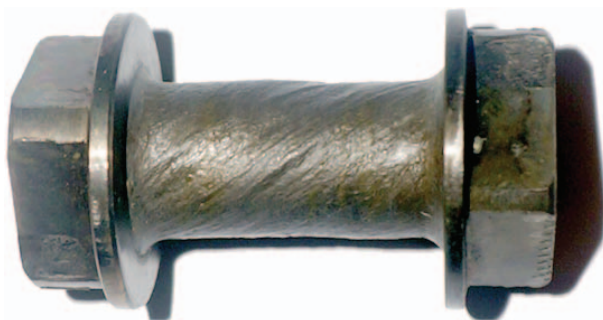
Рис. 5. Образец из сплава Ti–Al–Sn–V, вырезанный в продольном направлении из плиты толщиной 60 мм, после кручения постоянным моментом при температуре T = 700\text{ }^{\circ}\text{C}
