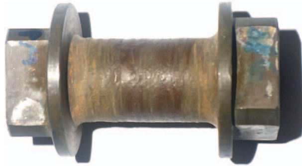
Рис. 3. Образец из сплава Ti–Al–Sn–V, вырезанный в направлении нормали из плиты толщиной 60 мм, после кручения постоянным моментом при температуре T = 700 °С
