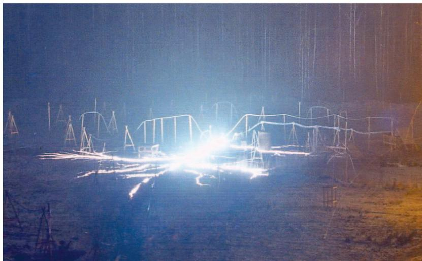
Рис. 8. Искровые каналы на поверхности грунта
