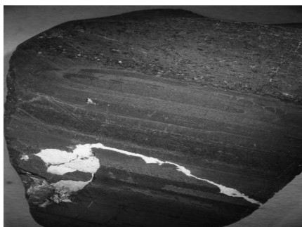
Рис. 1. Полированный образец тонкополосчатой гематит-браунитовой руды
