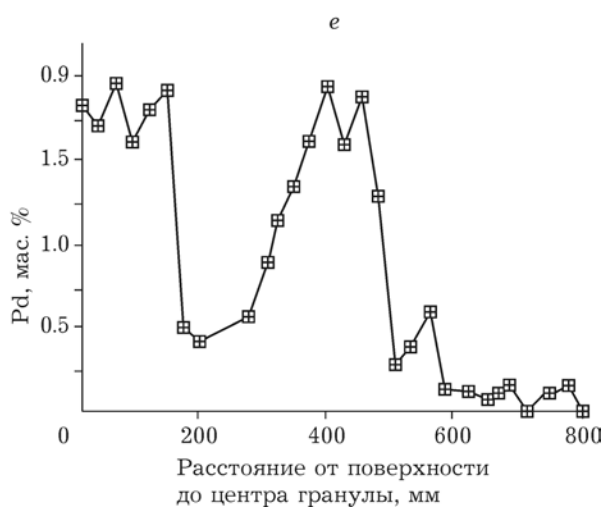
Рис. 2. СЭМ-снимки катализаторов PdЗГ ( a ), PdПР ( б ), PdАО ( в ) и локальная концентрация Pd по глубине гранул по данным EDX-анализа PdЗГ ( z ), PdПР ( д ), PdАО ( е ).
