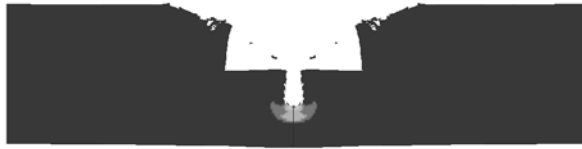
Рис. 6. Начальная стадия второго квазистационарного внедрения, образование новой ударной волны ( t = 11.896 мкс)
