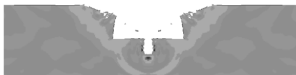
Рис. 5. Положение первой ударной волны сжатия вблизи нижней стороны пластины ( t = 11.5 мкс)
