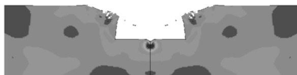
Рис. 3. Стадия формирования кратера: вершина струи ударяет в дно выемки ( t = 9.9991 мкс)
