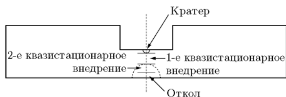
Рис. 9. Картина разрушения пластины ТС4
