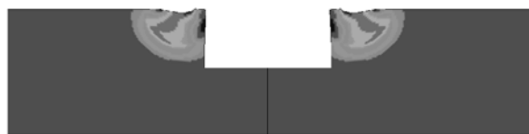
Рис. 2. Первичная ударная волна сжатия, вызванная осколками облицовки ( t = 3.8463 мкс)
