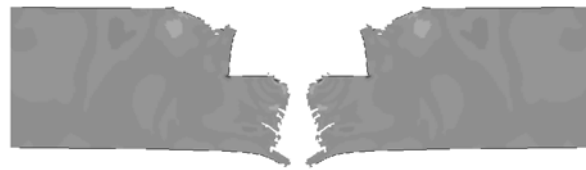
Рис. 8. Профиль разрушений, полученный моделированием ( t = 15.996 мкс)
