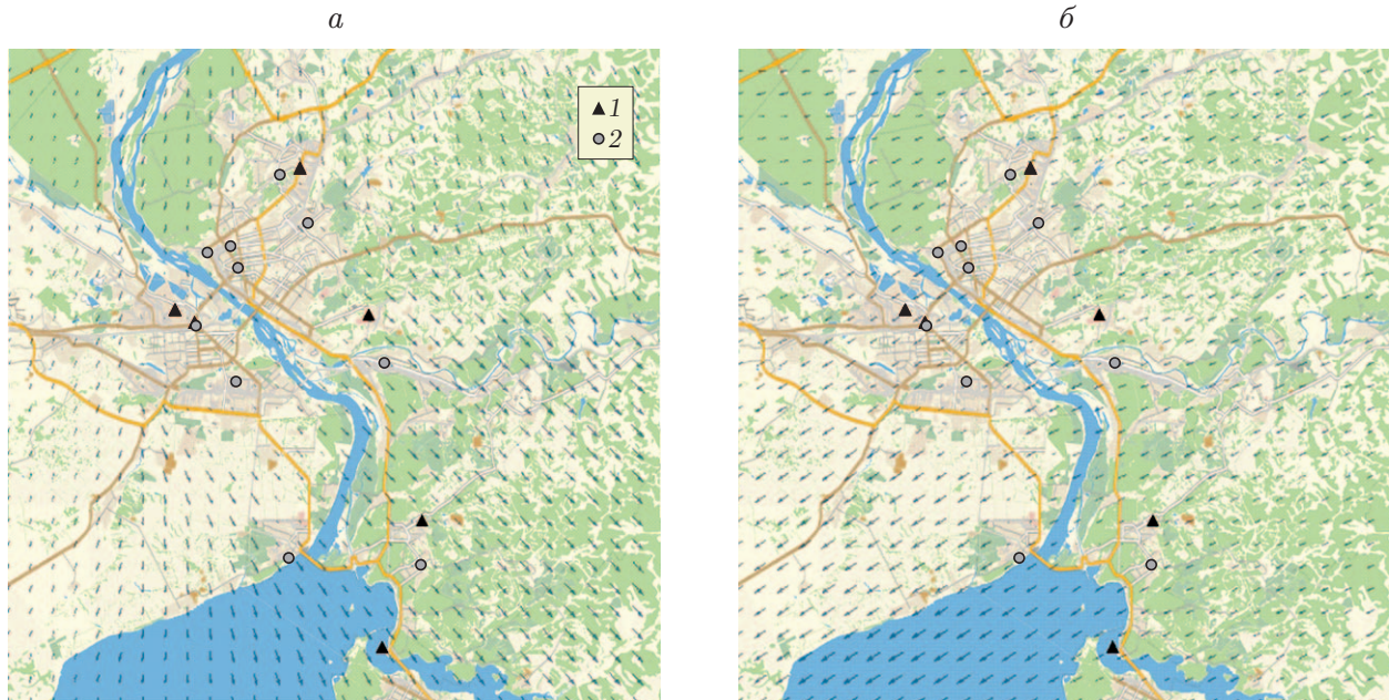
Рис. 1. Поле скоростей ветра в различные моменты времени с начала эксперимента: a — t = 4 ч, b — t = 8 ч; 1 — источники загрязнения, 2 — станции мониторинга [18]
