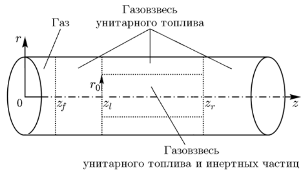
Рис. 1. К постановке задачи о прерывании распространения волны гетерогенной детонации слоем инертных частиц:
