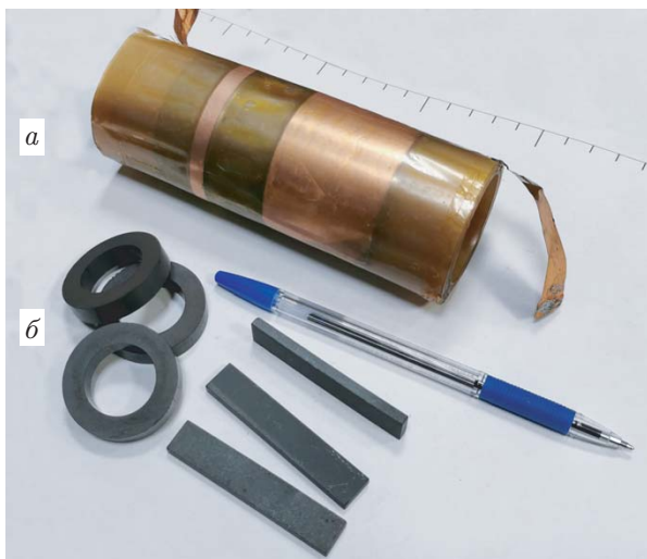
Рис. 3. Модифицированный генератор (а) и магнитопроводы (б)
