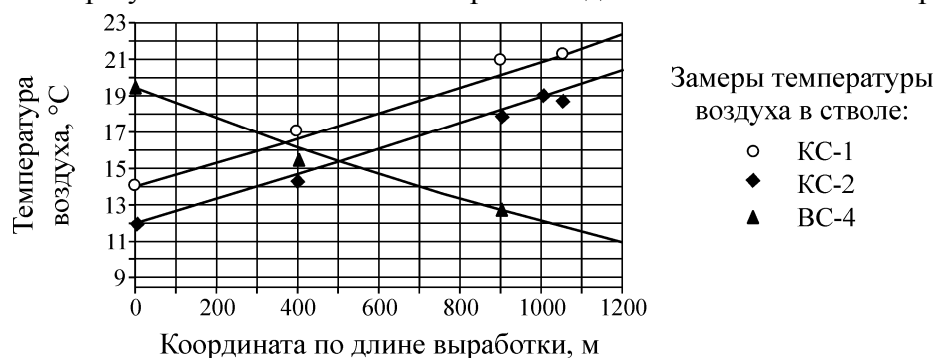
Рис. 3. Эпюра температур воздуха вдоль стволов рудника “Октябрьский”, полученная с помощью численного расчета, и результаты экспериментальных замеров температур в отдельных точках стволов
