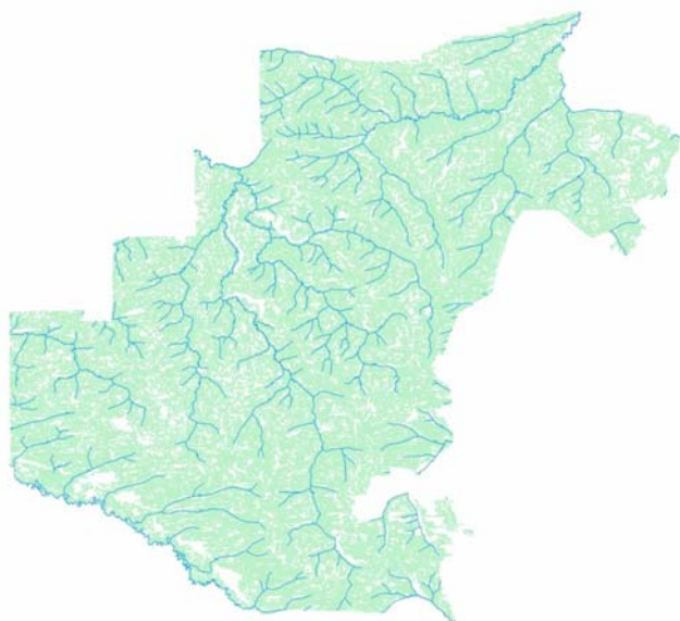
Рис. 3. Полигоны тестового участка, пересекаемые водотоками. Извлечены инструментом «Ближайший объект (Near)» из набора полигонов, образованных по градиентам уклона местности.
