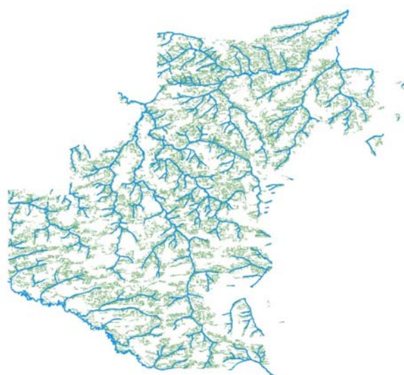
Рис. 2. Полигоны тестового участка, пересекаемые водотоками. Извлечены инструментом «Ближайший объект (Near)» из набора полигонов, образованных по показателям: уклон, экспозиция, вогнутость (выпуклость) поверхности.
