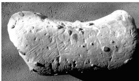
Рис. 4. Образец керна после 5 мин дезинтеграции
