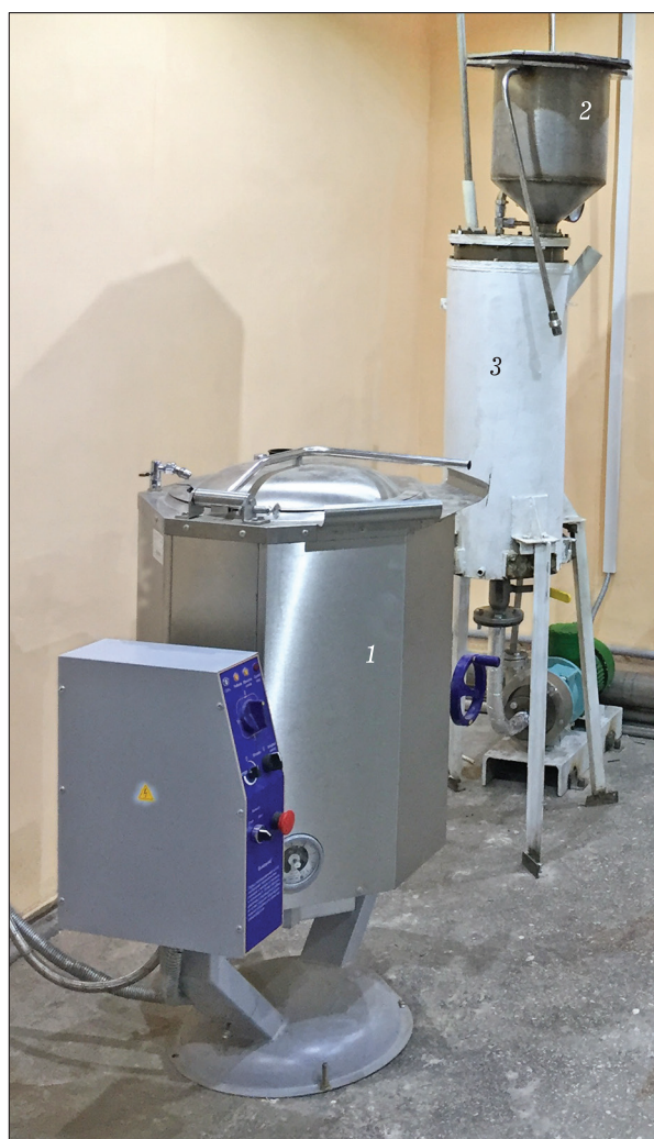
Рис. 2. Укрупненная лабораторная установка для переработки луба коры березы: 1 – реактор ( V = 60 л), 2 – вакуумный нутч-фильтр ( V = 30 л), 3 – приемная емкость ( V = 60 л).
