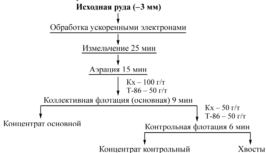
Рис. 2. Технологическая схема исследований медно-никелевой руды
