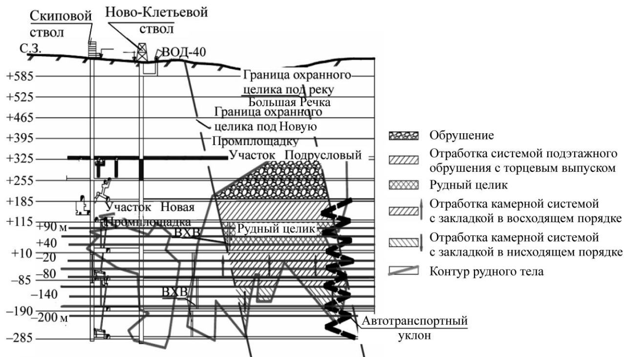
Рис. 2. Расположение предохранительных целиков на Шерегешевском месторождении
