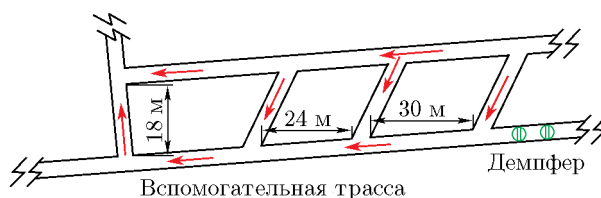
Рис. 1. Схема локальной вентиляционной системы в угольной шахте
