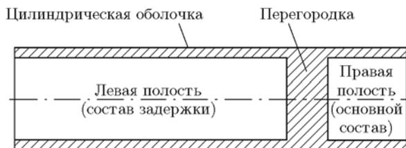
Рис. 1. Схема элемента тепловой задержки
