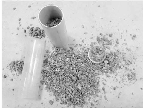
Рис. 9. Внешний вид разрушенных контрольных образцов
