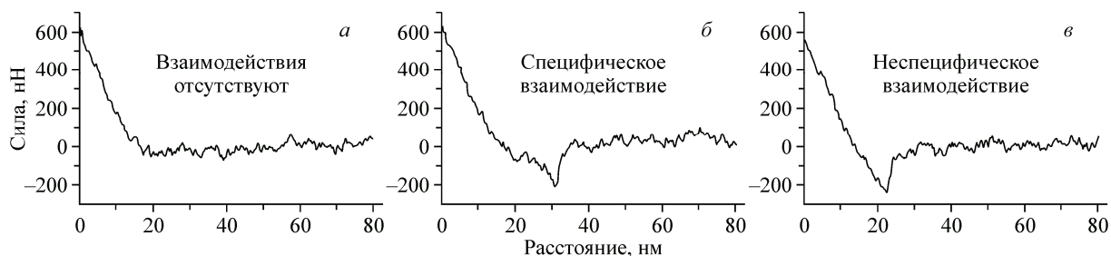
Рис. 6. Типичные силовые кривые: силовая кривая без взаимодействий (а); силовая кривая, соответствующая специфическому взаимодействию между молекулами (б); силовая кривая с неспецифическим взаимодействием [ 18 ] (в)
