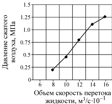
Рис. 5. Зависимость скорости перетока жидкости от давления сжатого воздуха
