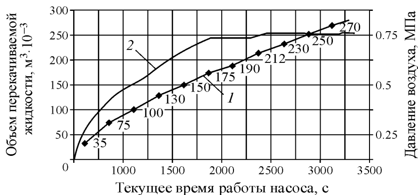
Рис. 6. Динамика изменчивости перетока рабочей жидкости из камеры № 1 в камеру № 2 при работе насоса: 1 — изменение объема жидкости в камере № 2; 2 — изменение избыточного давления воздуха в камере № 2
