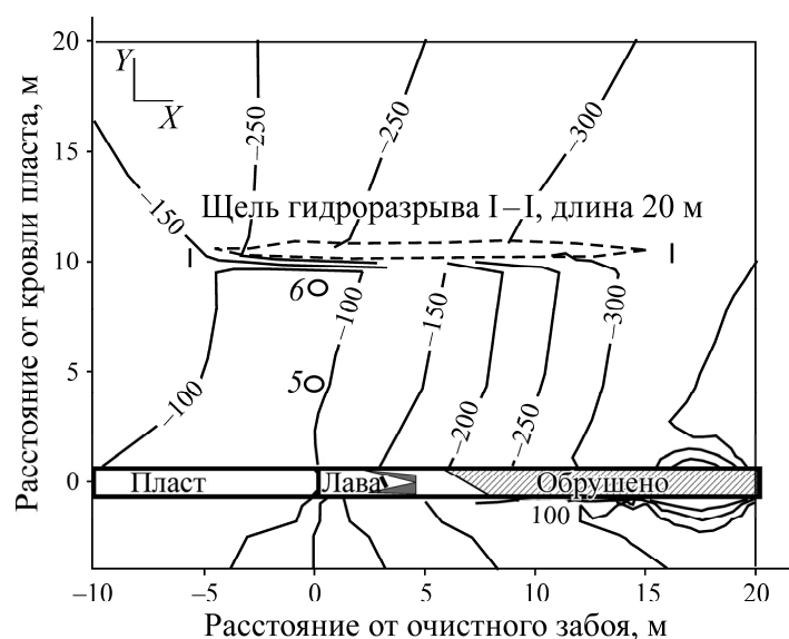
Рис. 7. Оседания пород (мм) в окрестности очистного забоя после формирования инициирующей щели длиной 20 м в кровле пласта
