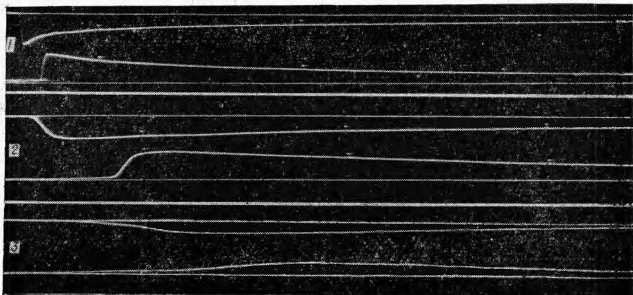
Рис. 2. Копии осциллограмм массовой скорости. Интервал между метками времени 1 мсек.
