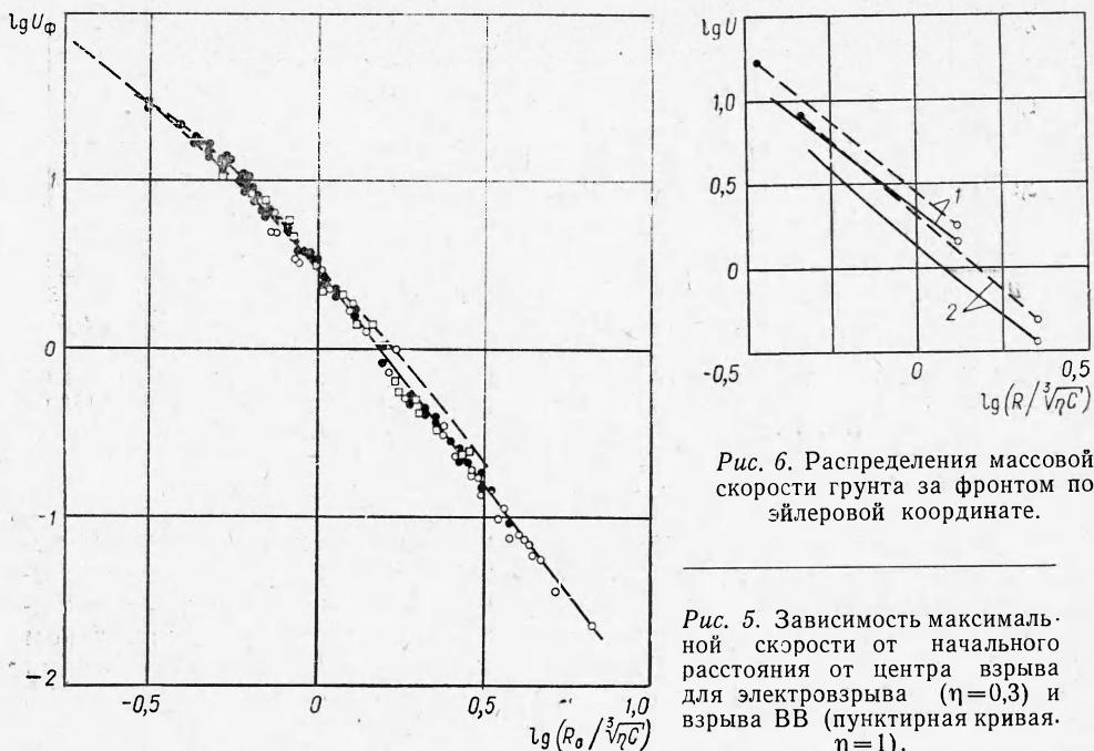
Рис. 6. Распределения массовой скорости грунта за фронтом по эйлеровой координате.
