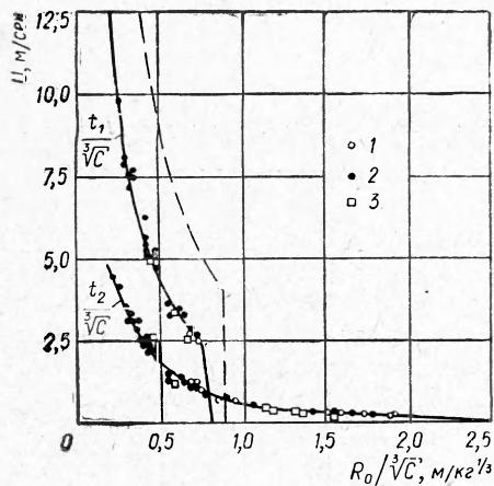
Рис. 3. Распределение массовой скорости грунта по начальной приведенной координате.
