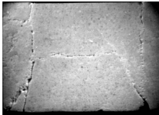
Рис. 4. Диаметральное сечение образца ВВ после опыта на локализованный сдвиг ( \sigma_i = 100 \text{ МПа} , \dot{\epsilon} = 200 \text{ с}^{-1} ( v_{\text{нагр}} = 4.0 \text{ м/с} ))
