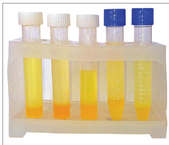
Рис. 2. Общий вид образцов фильтрата речной воды ( \text{pH} \leq 2.0 ) после расслаивания в системе “вода – тиопирин – салициловая кислота”, модифицированной спиртом.
