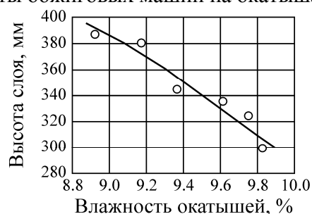
Рис. 4. Влияние влажности окатышей на высоту слоя их укладки
