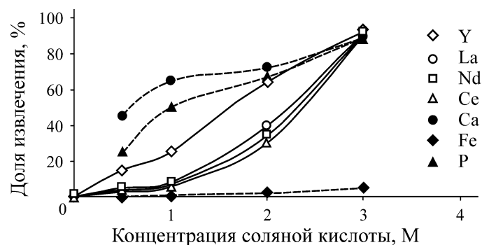
Рис. 6. Доля извлечения РЗЭ и загрязнителей при различных значениях концентрации азотной кислоты: температура 25 °С, время выщелачивания 2.5 ч, соотношение жидкость : твердое вещество 5 : 1
