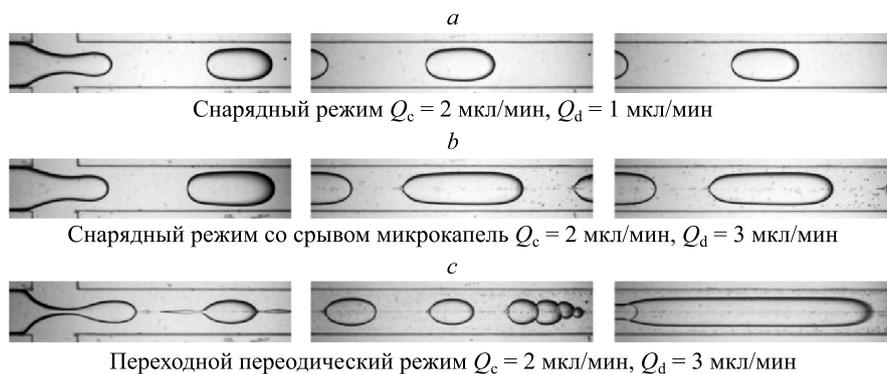
Рис. 3. Характерные режимы течения для системы ПДМС — вода в  $X$ -канале в области формирования и на расстояниях 8,5 мм и 15 мм от нее при различных расходах несущей  $Q_c$  и дисперсной  $Q_d$  фаз.
