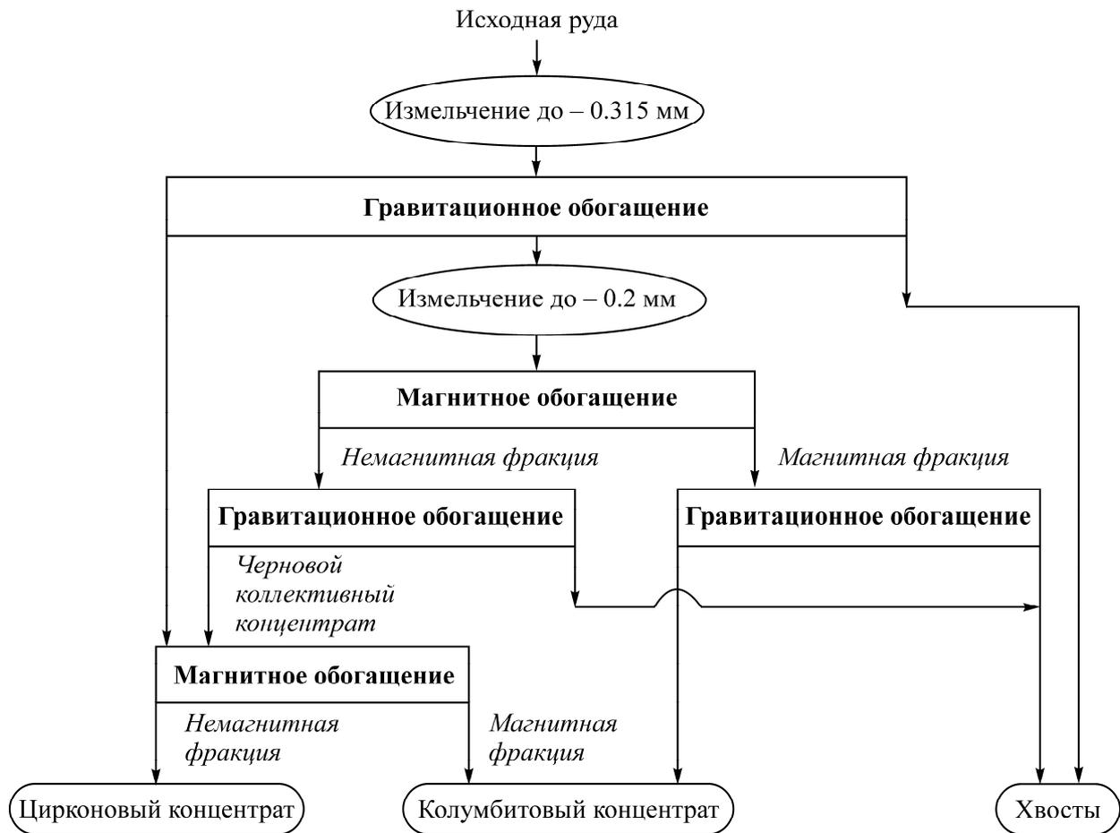
Рис. 7. Технология переработки перспективной тантал-ниобиевой руды
