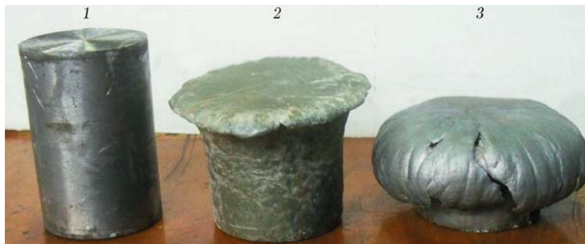
Рис. 5. Бризантность различных ЭМВВ, характеризуемая сжатием свинцового блока:
