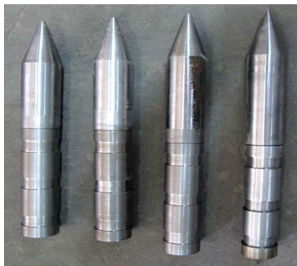
Рис. 10. Картриджи для кольцевой кумулятивной резки, предназначенные для ликвидации глубоководного прихвата
