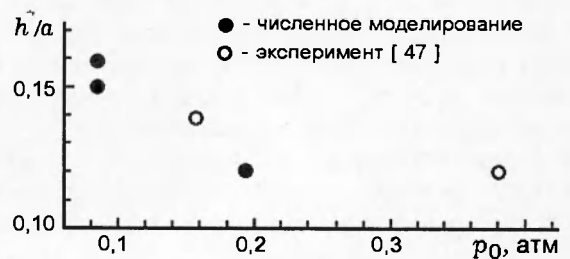
Рис. 7. Зависимость максимальной неровности фронта ДВ от начального давления для смеси 2\text{H}_2 + \text{O}_2
