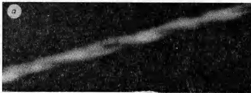
Рис. 3. Фоторегистрограмма распространения детонации в смеси водонаполненного гранулированного тротила с добавкой 40% железистого кварцита с \delta=1,5 мм; d=160 мм, l=3,5 м, материал оболочки полиэтилен (а) и торцевой отпечаток фронта детонации этой же смеси на латунном диске (б).
