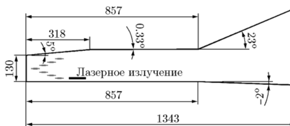
Рис. 1. Схема модельной камеры сгорания и части сопла:
