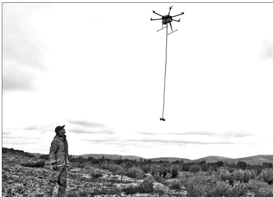
Рис. 1. «Тяжелый» мультикоптер с магнитометром.
