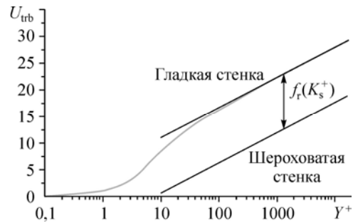
Рис. 2. Сдвиг логарифмического профиля скорости вследствие учета шероховатости поверхности [13, 14].
