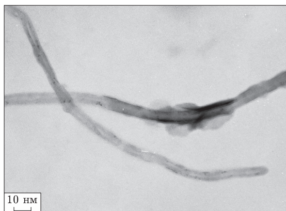
Рис. 2. Изображение ПЭМ образца композиционного материала МУНТ/Ni-1.
