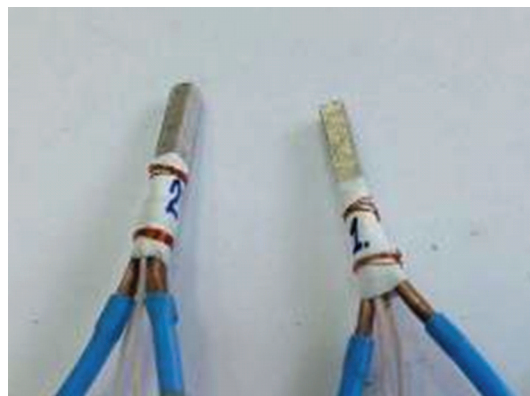
Рис. 3. Фотография датчика с размерами рабочей поверхности 2.3 \times 2.3 мм для измерения кондуктивных и лучистых тепловых потоков
