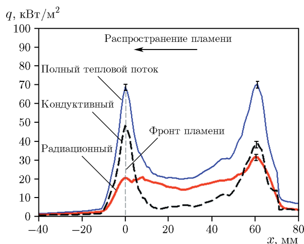
Рис. 5. Зависимости плотности полного, радиационного и кондуктивного тепловых потоков от расстояния до фронта пламени при горении литой пластины ПММА толщиной 4.6 мм, измеренные датчиком размеров 2.3 \times 2.3 \text{ мм} :
